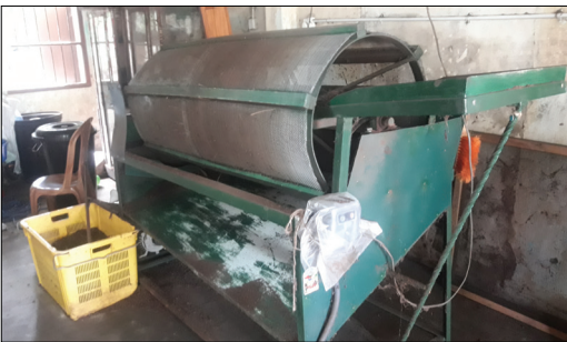
යන්ත්‍රිකව ක්‍රියා කරන කුඩා පරිමාණයේ සිලින්ඩරාකාර සල්ලඬිය - ධාරිතාවය පැයකට කොම්පෝස්ට් කිලෝ 500 - 800
