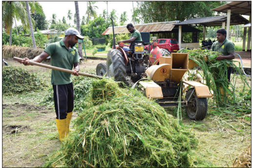
සිවු රෝද ට්‍රැක්ටරයෙන් ක්‍රියාකරන ද්විත්ව ක්‍රියාකාරී අමුද්‍රව්‍ය කැබලි කිරීමේ යන්ත්‍රය - ධාරිතාවය පැයට අමුද්‍රව්‍ය කිලෝ 800 - 1000 පමණ
