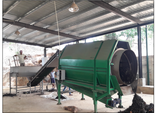
මහා පරිමාණයේ කොම්පෝස්ට් පොහොර නිෂ්පාදනාගාරයකට අර්ධ ස්වයංක්‍රීය සිලින්ඩර සල්ලඬිය - පැයකට කොම්පෝස්ට් කිලෝ 1000 - 1200 ක් සැකසිය හැක.
