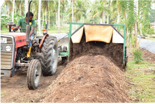
සිවුරෝද ට්‍රැක්ටරයෙන් ක්‍රියාකරන මාකදුර ගොඩ පෙරළන යන්ත්‍රය
