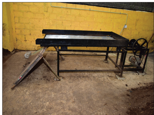
යාන්ත්‍රිකව ක්‍රියාකරන තැටි ආකාරයේ සරල සල්ලෙඩය - ධාරිතාවය පැයට කොම්පෝස්ට් කිලෝ 500 - 800 පමණ
