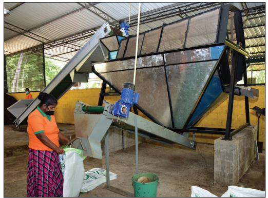
මහා පරිමාණයේ නිෂ්පාදනාගාරයකට සුදුසු ස්වයංක්‍රීය සල්ලඬිය - පැයකට කොම්පෝස්ට් කිලෝ 1000ක් පමණ හලා බෑන් කර දෙයි. මෙහි ඇති ෂඩ්‍රාකාර හැඩය නිසා හලන අවස්ථාවේ දී සල්ලඬිය තුළ කොම්පෝස්ට් බෝල සෑදීම වැලැක්විය.
