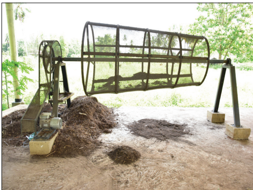
මධ්‍යම පරිමාණයේ කොම්පෝස්ට් පොහොර නිෂ්පාදනාගාරයකට සුදුසු යන්ත්‍රිකව ක්‍රියාකරන සිලින්ඩරාකාර සල්ලඬිය - ධාරිතාවය පැයකට කොම්පෝස්ට් කිලෝ 800 - 1000
