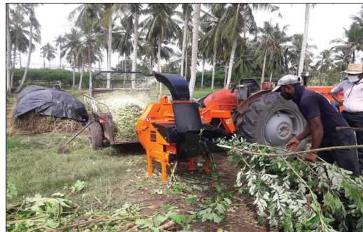
සිවු රෝද ට්‍රැක්ටරයෙන් ක්‍රියාකරන නවීන කැබලි කරන යන්ත්‍රයක් - ධාරිතාවය පැයට අමුද්‍රව්‍ය කිලෝ 1000 - 1500 පමණ
